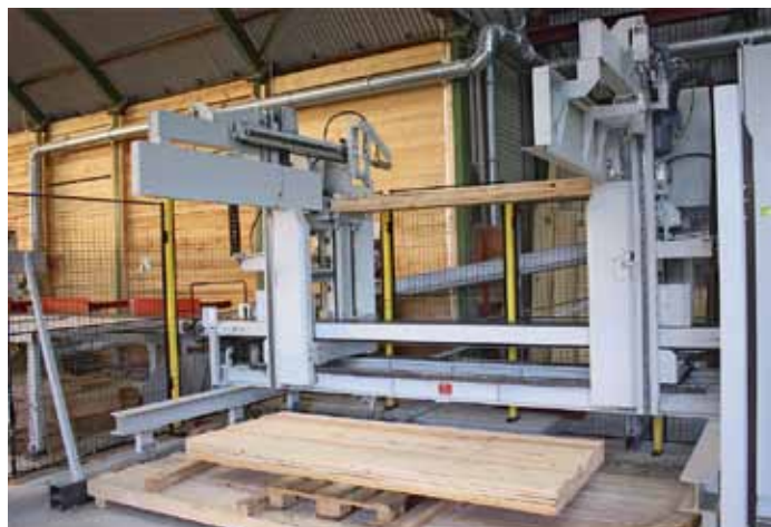
Die vierte Abwurfstation ist mit einer Reinhardt-Stapelanlage ausgerüstet – bis 3 m lange Zuschnitte lassen sich automatisch pakettieren
